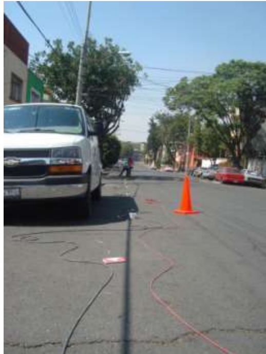
Figura 5. 29. Adquisición de datos MASW en Salvador Díaz Mirón.
