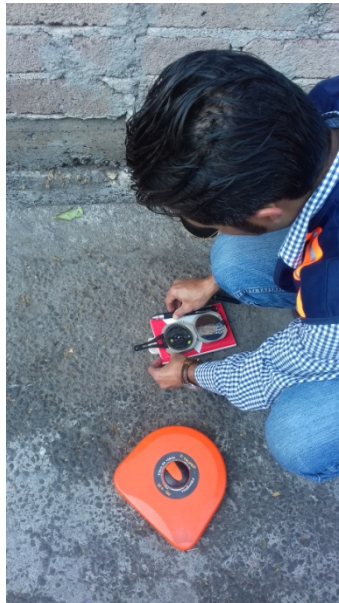
Figura 5. Empleo de la Brújula Brunton para la medición de la orientación.
