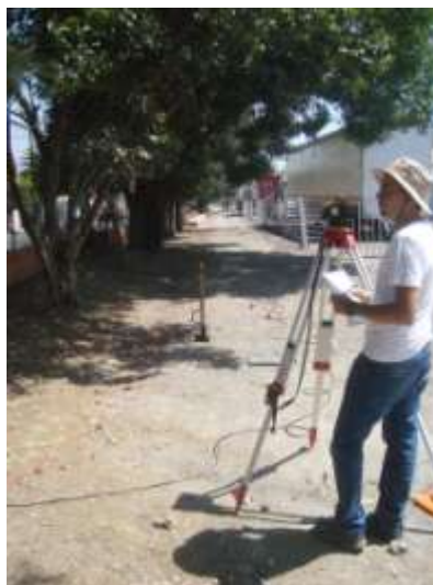
Figura 5. 19. Adquisición de datos MASW en San Lorenzo Xicoténcatl.
