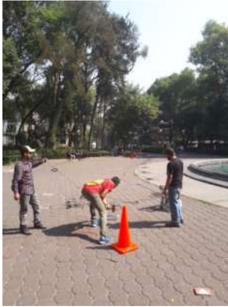
Figura 5. 40. Adquisición de datos MASW en la Plaza Rio de Janeiro, Roma Cuauhtémoc.
