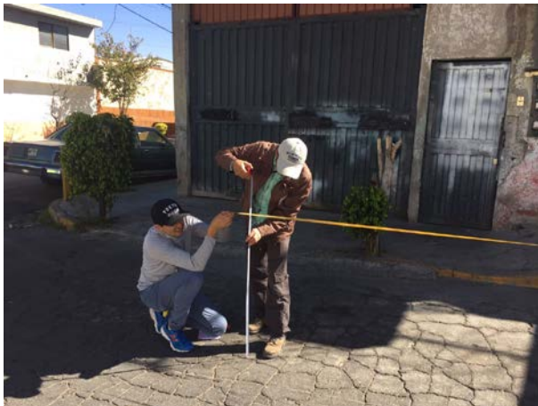
Figura 6. Desplazamiento vertical en zonas de fracturamiento empleando cinta métrica y flexómetro
