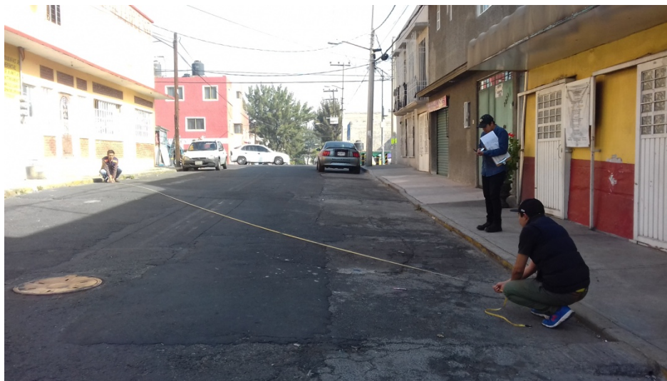
Figura 7. Medición de la apertura de fracturamiento, este se realizó de manera perpendicular a la dirección de fracturamiento.
