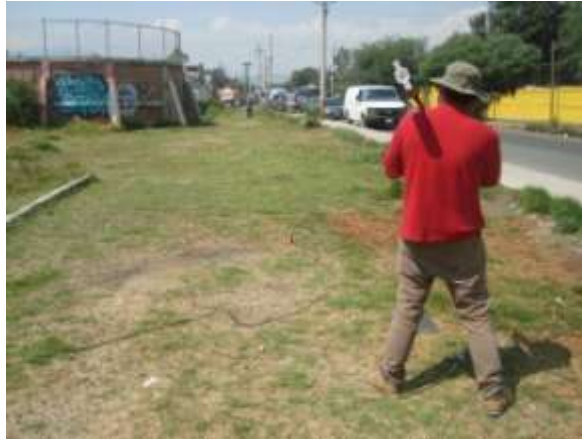
Figura 5. 12. Adquisición de los datos MASW, en Villa Centroamericana.
