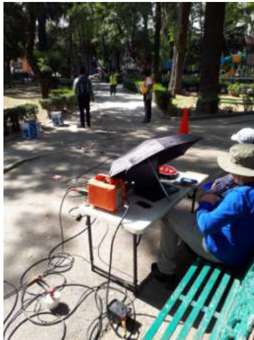
Figura 5. 47. Adquisición de datos MASW en Narvarte Cuauhtémoc.
