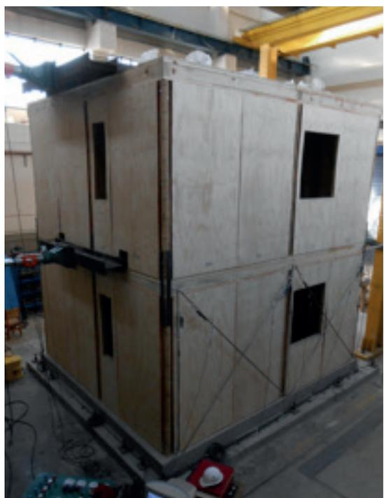
Vista general del modelo a escala natural del edificio de madera y bambú sujeto a cargas laterales del tipo sísmico, en el Laboratorio de Estructuras Grandes del CENAPRED
