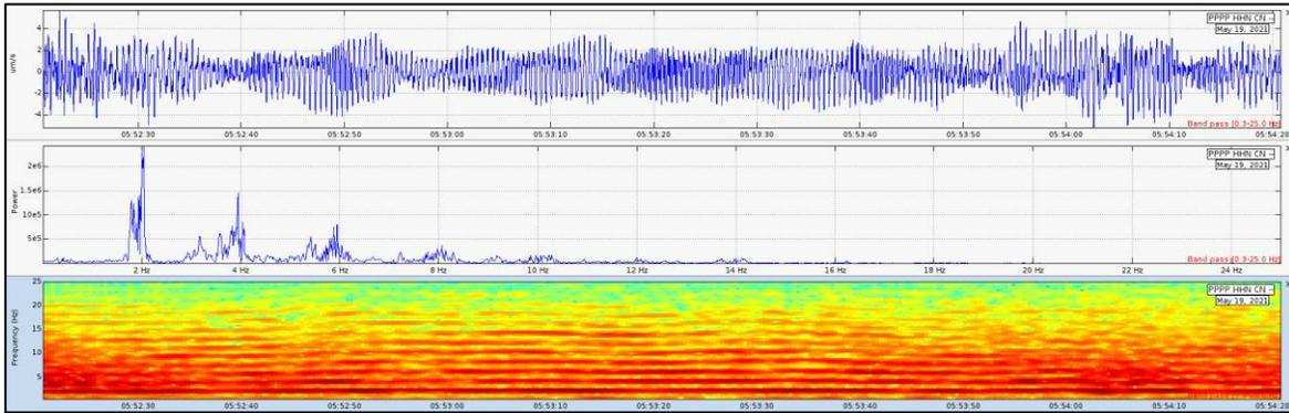
**Figura 4** Forma de onda, espectro y espectrograma de un segmento de tremor armónico registrado el 19 de mayo en el componente norte de la estación Canario
