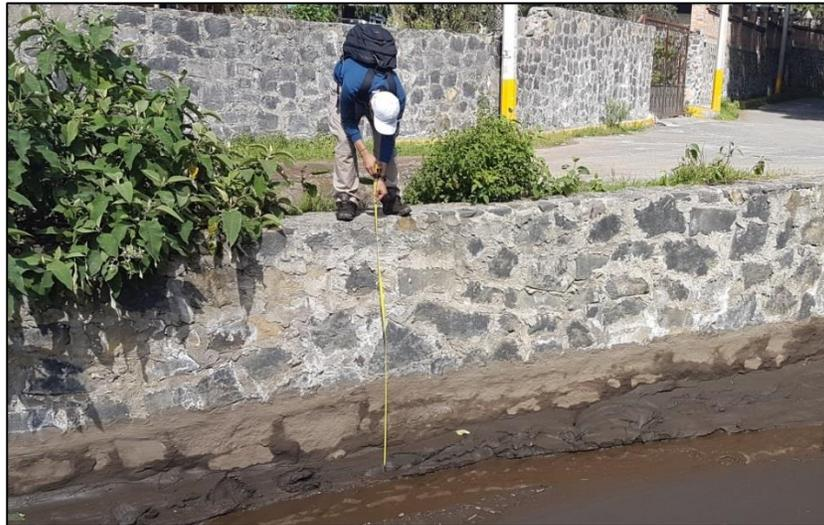
*Figura 39 Medición de espesores del flujo en Tehuixtitlán*
