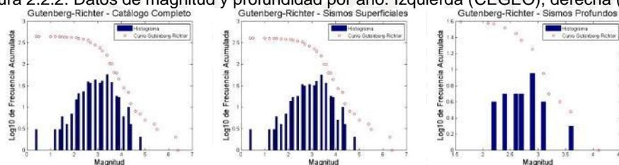
Figura 2.2.3. Relación Gutenberg-Richter de los datos depurados del catálogo del CEGEO.
