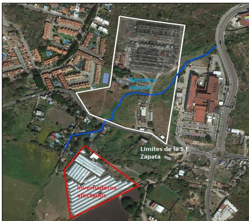
Figura 5 Localización de la zona afectada en color rojo (invernaderos) y en color blanco se encuentra la subestación Zapata, mientras que en azul se representa la barranca natural por la que se conduce los escurrimientos pluviales
