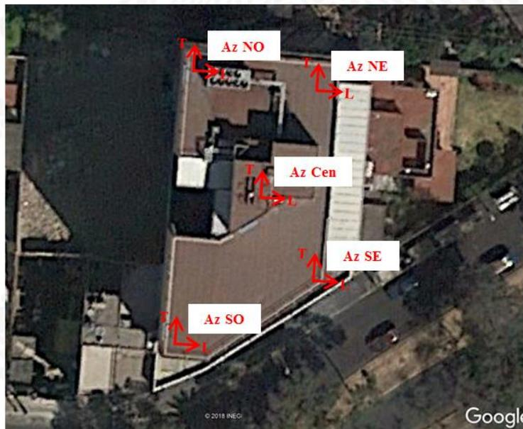
**Figura 2.1.** Ubicación en planta de los puntos en donde se tomaron registros de vibración ambiental.
