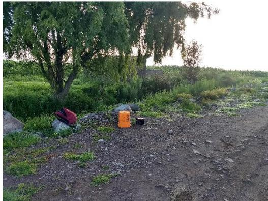
**Figura 2.5** Fotografías de algunos puntos donde se tomaron registros y equipo empleado en la medición de vibración ambiental del suelo (Sismómetros Guralp 6TD).
