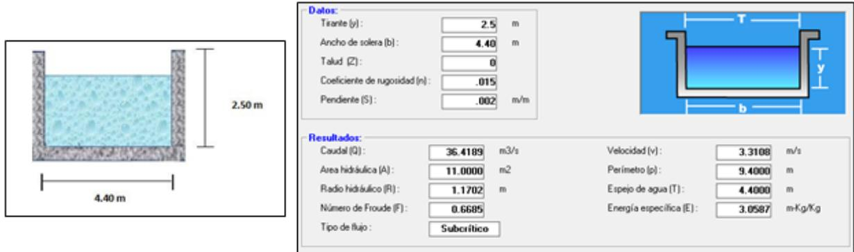
Figura 8. Capacidad hidráulica del canal perimetral de Valle Alto, ciudad de Culiacán (Fuente: HCanales, 2013)
