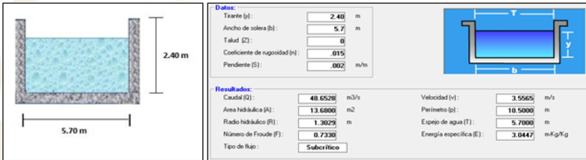
Figura 14. Sección y capacidad hidráulica en los puentes y en el tramo final del canal en la colonia Humaya, ciudad de Culiacán (Fuente: HCanales, 2013)
