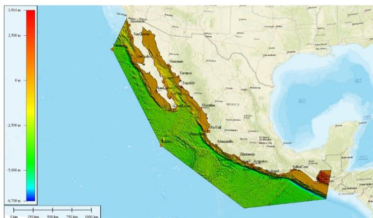
**Figura 13 Cobertura del modelo digital de elevaciones del fondo marino GEBCO, para el océano Pacífico mexicano (Fuente: Elaboración propia)**
