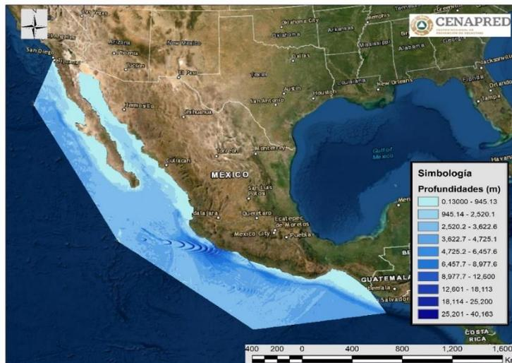
**Figura 16 Profundidades del nivel el mar por efecto del evento sísmico M8.6, obtenidas por medio de simulación hidrodinámica (Fuente: Elaboración propia)**
