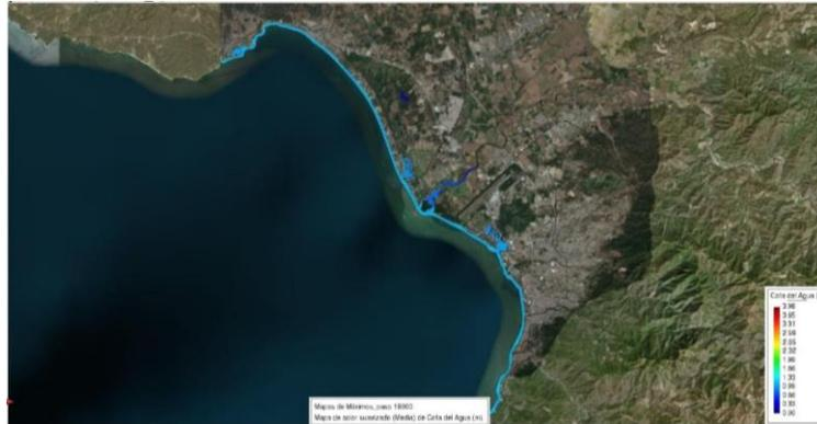
**Figura 29 Simulación de tsunami en la costa de Puerto Vallarta, Jalisco y área conurbada (Fuente: Elaboración propia)**
