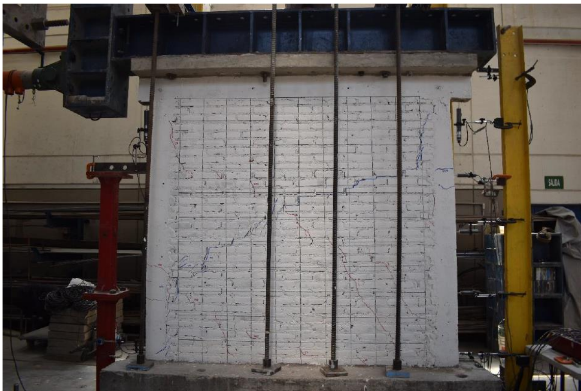
Figura 16.e. Modelo M-13, patrón de daño a 0.5% de distorsión
