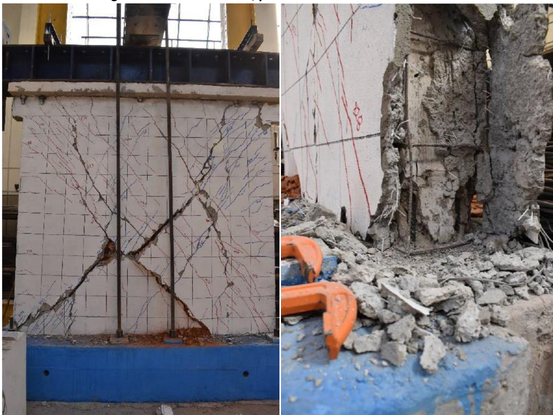
Figura 16.d. Modelo M-7, patrón de daño a 0.5% de distorsión
