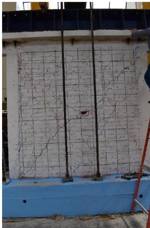
Figura 16.d. Modelo M-7, patrón de daño a 0.5% de distorsión
