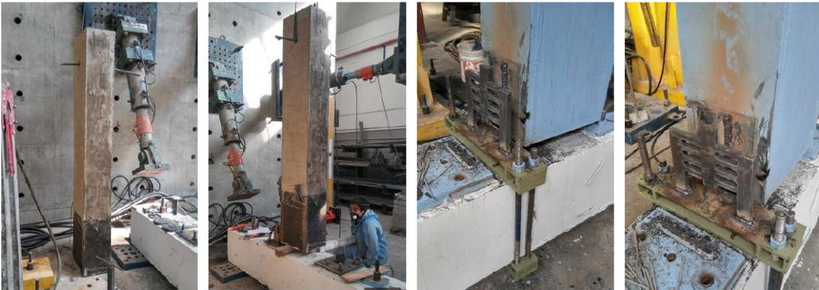
**Figura 6** Fotografías que muestran el proceso de montaje de la conexión viga – columna
