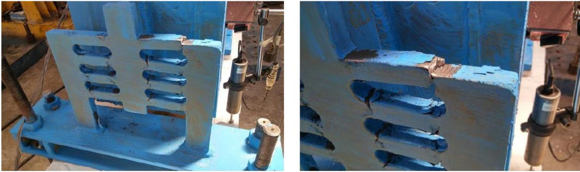
**Figura 16 Estado final del dispositivo disipador ensayado**
