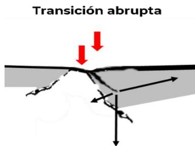
**Figura 27. Clasificación de la propagación de grietas por transición abrupta**
