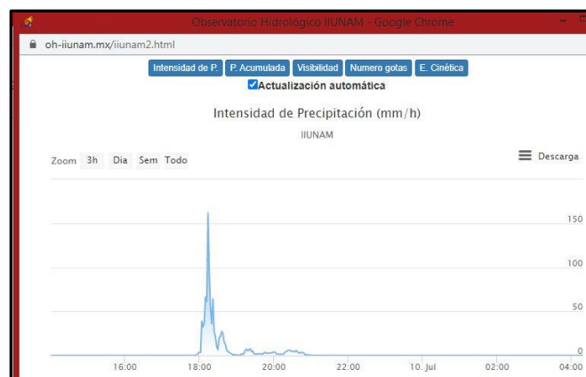
Figura 4.2 Registro de intensidad de precipitación del 09 de julio de 2020 en el disdrométero instalado en el Instituto de Ingeniería de la UNAM
