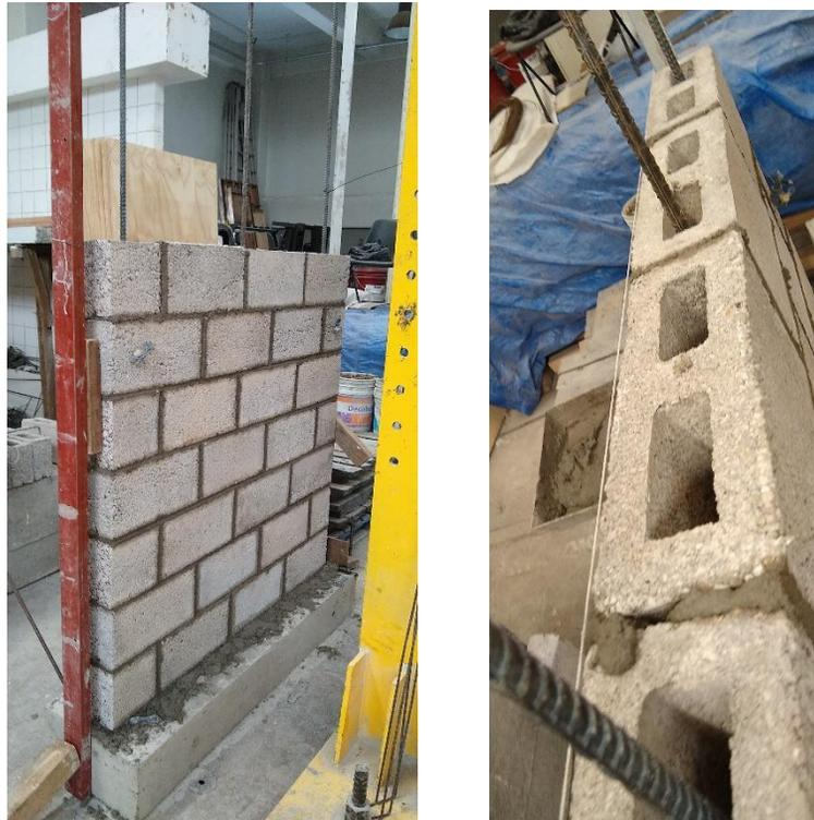
**Figura B.3** Especímenes MBV-3 (con tres barras verticales del no. 6)
