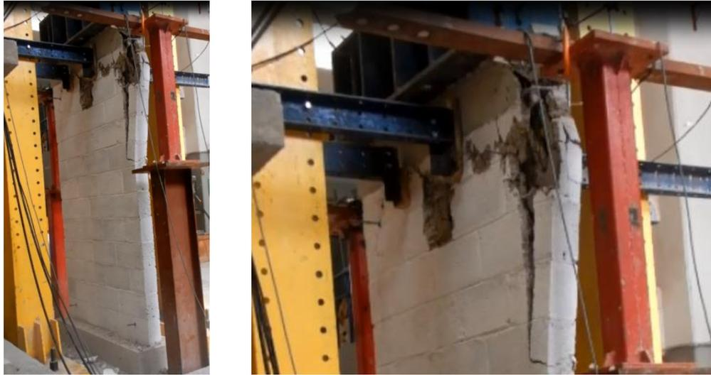
**Figura 3.5** Daño en el estado final de la falla del espécimen MBV-3
