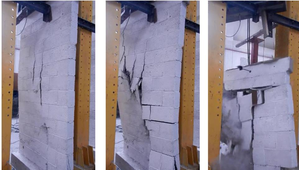
**Figura 3.1** Secuencia de la falla y colapso del espécimen MBV-1
