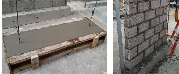
**Figura B.2** Cimentación y construcción del especímenes MBV-2 (con dos barras del no. 3)
