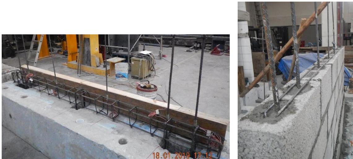
**Figura B.5** Anclaje a la base y construcción de especímenes con refuerzo horizontal
