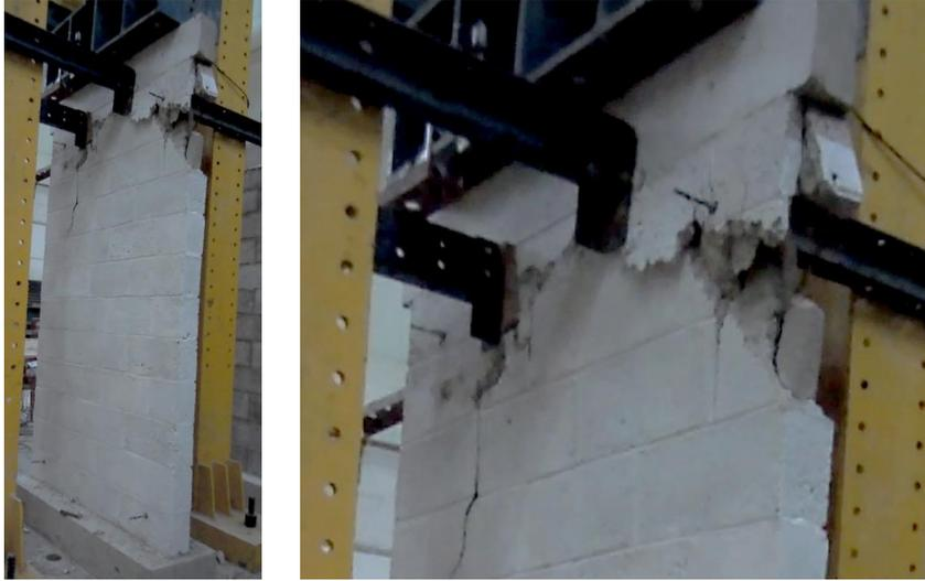
Figura 3.3 Daño en el estado final de la falla del espécimen MBV-2
