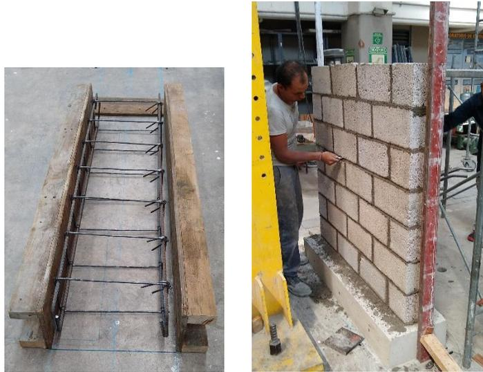
*Figura B.1 Cimentación y construcción del especímenes MBV-1 (sin refuerzo vertical)*
