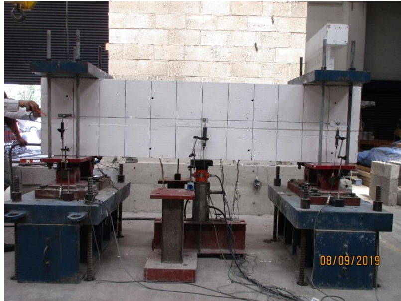
Figura 19 Viga a torsión (VT1)
