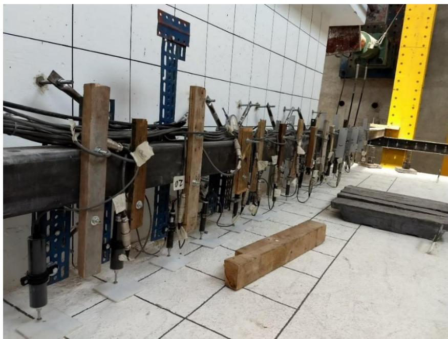
Figura 10. Instalación de LVDTs a lo largo de la losa
