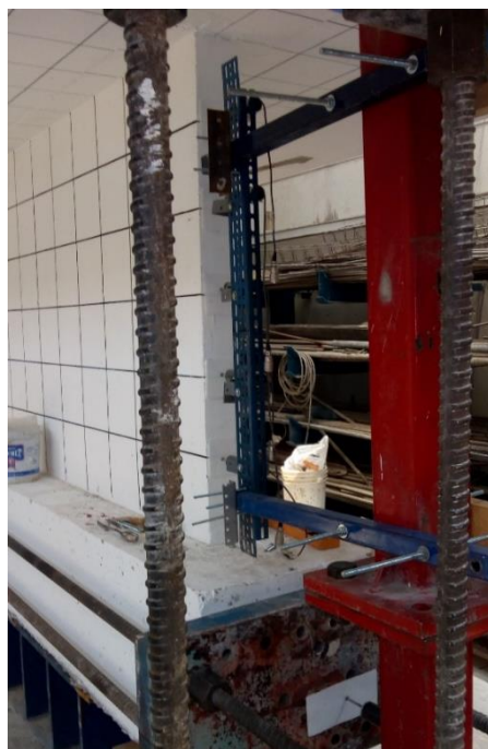
Figura 12. Instalación de LVDTs en el muro inferior
