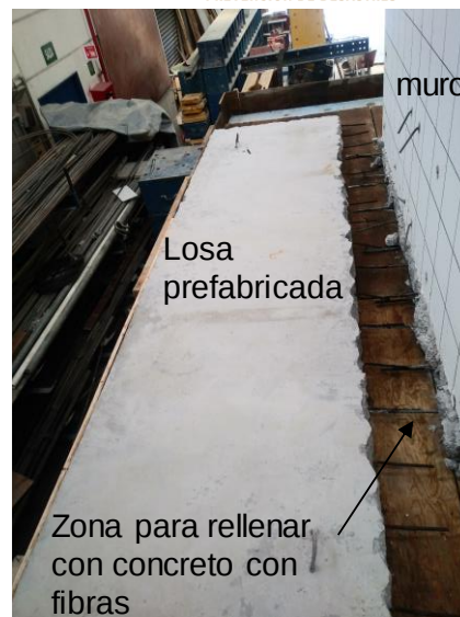
a) Esquema de segmentos prefabricados b) fotografía de elementos prefabricados
