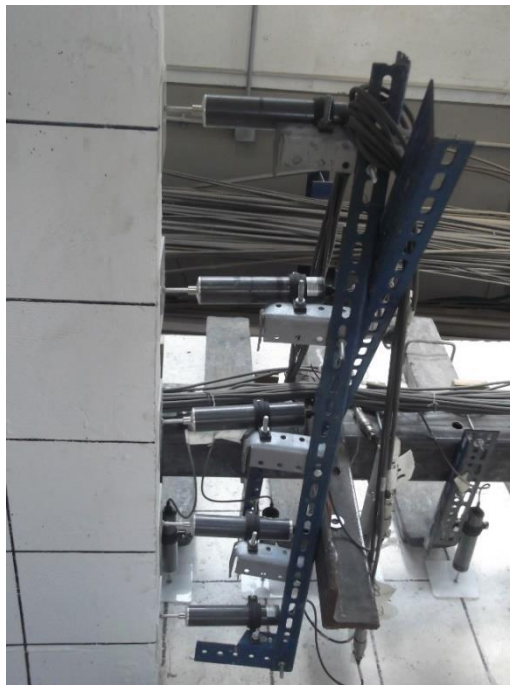
Figura 11. Instalación de LVDTs en el muro superior
